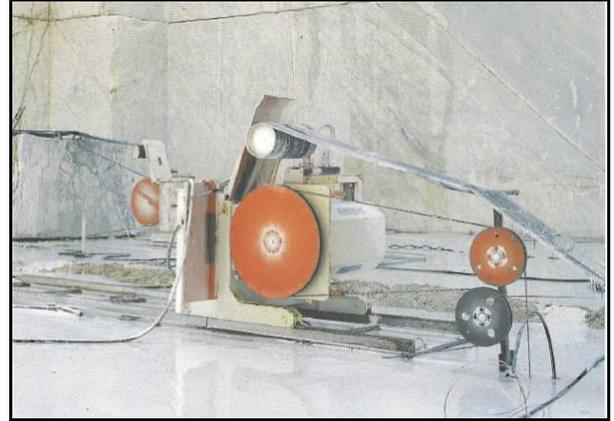
Modèle de scie au fil diamanté
